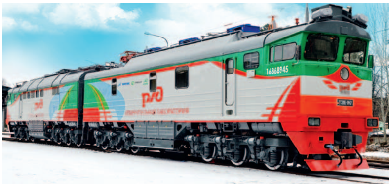
Рис. 1. Самоходная многофункциональная диагностическая лаборатория на базе тепловоза 2ТЭ116
