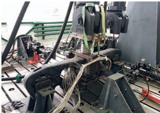
Рис. 12. Приложение вертикальной нагрузки в места опирания пружин рессорного комплекта
