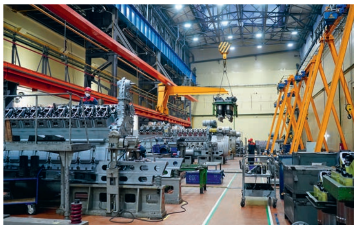
Эталонная линия по сборке дизельных двигателей и обрабатывающие центры на Коломенском заводе
