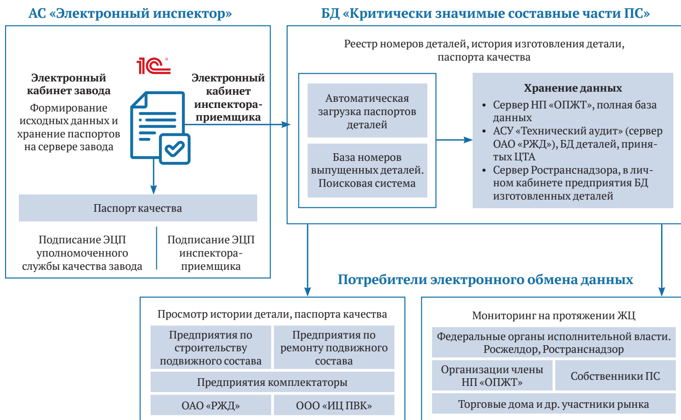
Рис. 1. Схема формирования базы данных АС «Электронный инспектор»
