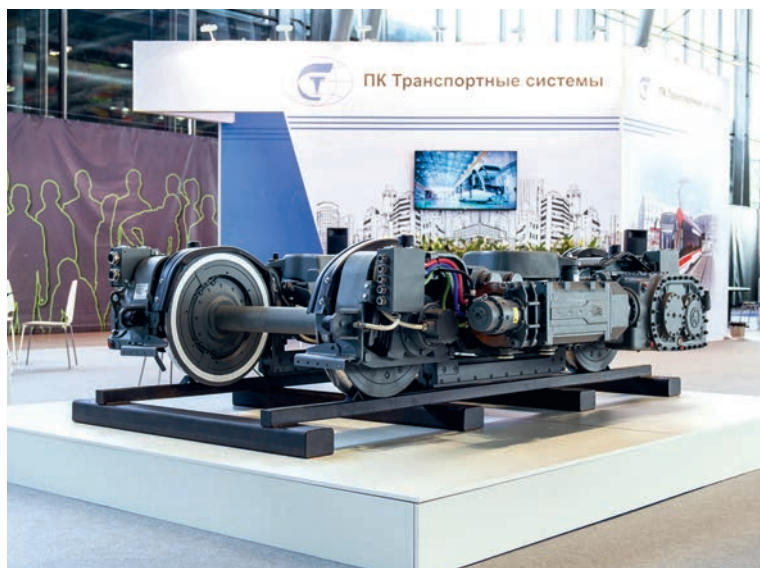
Рис. 2. Тележка ПК ТС для путей 1000 мм
