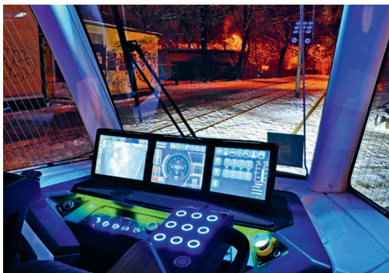
Рис. 4. Пульт управления в кабине водителя трамвая 71-921 «Корсар»
