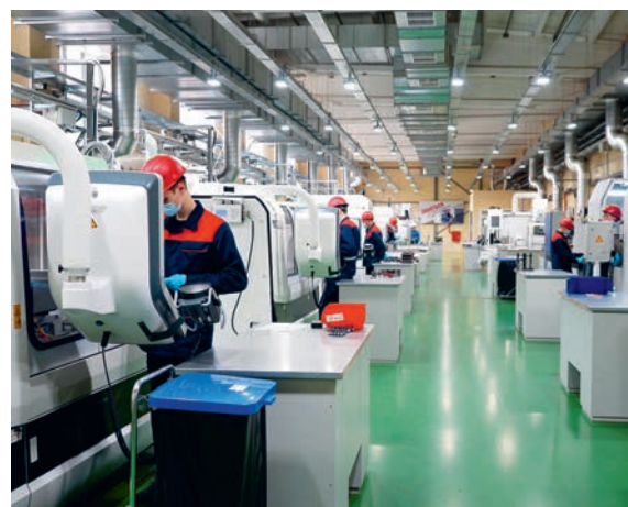
Эталонная линия по сборке дизельных двигателей и обрабатывающие центры на Коломенском заводе
