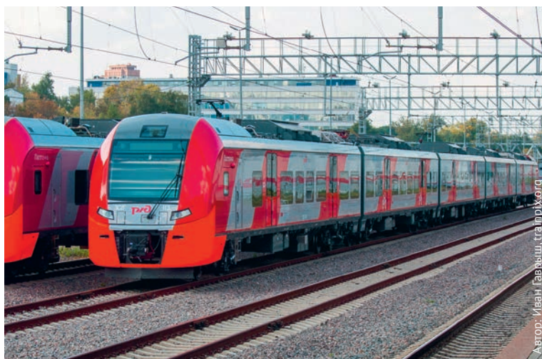
Электропоезд ЭС2Г-113 «Ласточка», оборудованный для эксплуатации на уровне автоматизации GoA3
