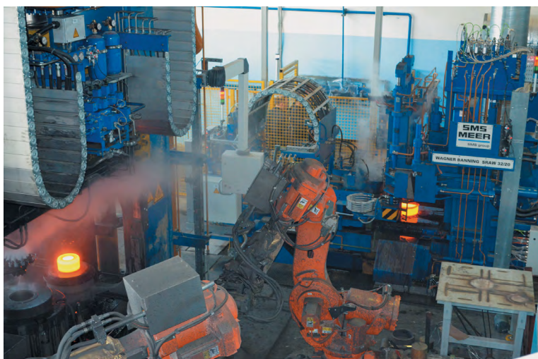
Рис. 1. Внешний вид роботизированной линии SMS Meer в процессе выполнения ковочных операций
