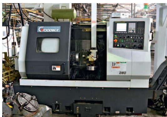
Рис. 3. Автоматический станок, выполняющий операцию «твердого» токарного точения
