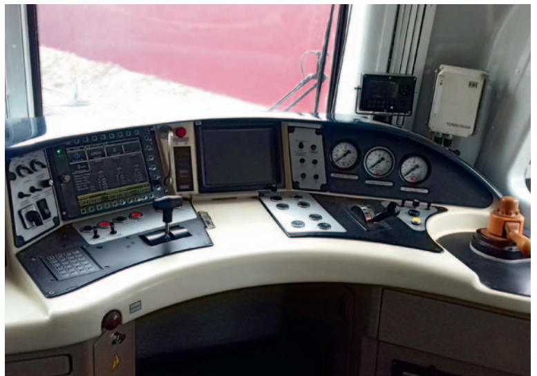
Рис. 3. Рабочее место машиниста тепловоза
