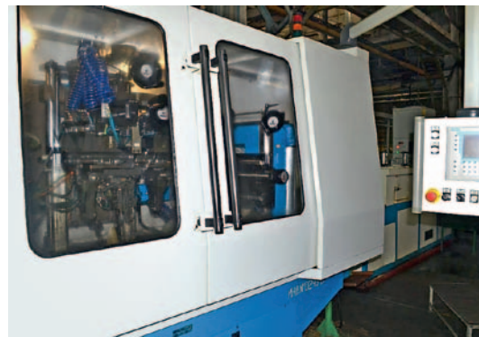
Рис. 2. Суперфинишный автомат, применяемый для финишной обработки колец
