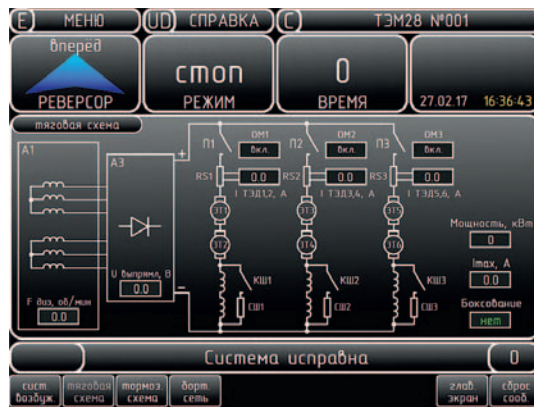
Рис. 5. Диагностическая панель «Тяговая схема»
