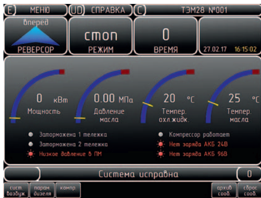
Рис. 4. Панель дисплея машиниста
