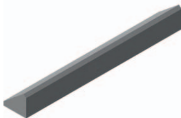
Рис. 1. Общий вид деревянного отбойного бруса
