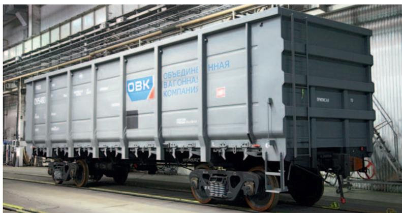
Рис. 7. Полувагон с осевой нагрузкой 27 тс
