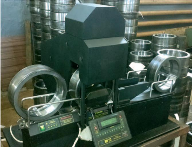
Рис. 1. Вихретоковый дефектоскоп ВД-233.100
