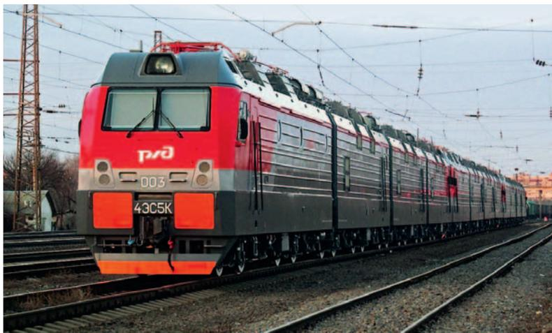
Рис. 3. Электровоз серии ЭС5К в 4-секционном исполнении
