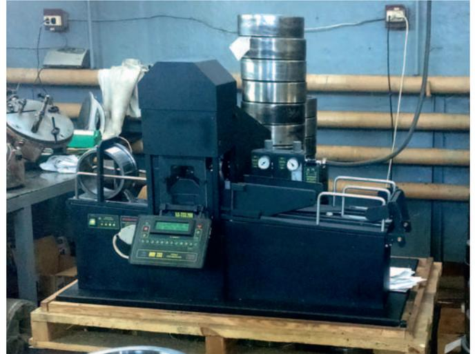
Рис. 2. Вихретоковый дефектоскоп ВД-233.200
