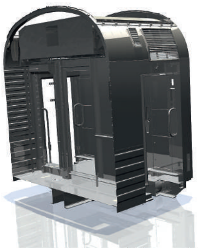
Рис. 2. Фрагмент кузова пассажирского вагона, подготовленного в качестве исходных данных для поставщика наружных дверей, и предоставленная модель торцевой двери
