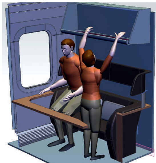
Рис. 4. Эргономическая проработка купе повышенной комфортности
