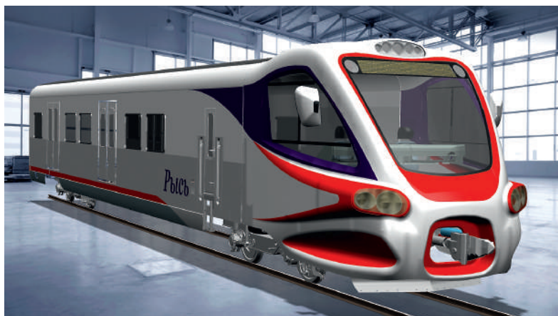
Рис. 7. Концепт головного вагона пригородного электропоезда
