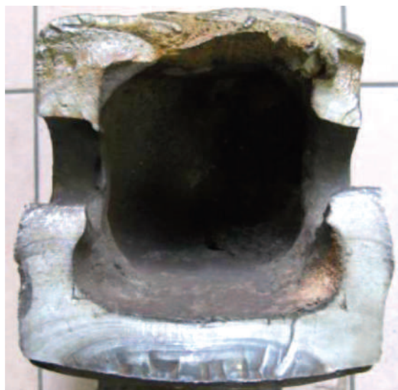
Рис. 2. Излом боковой рамы № 39522
