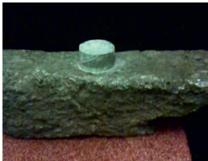
Рис. 4. Выступ, прибетонированный к плите через 2 месяца. Сила сцепления  $P2_{сц} > 315 \text{ кгс}$
