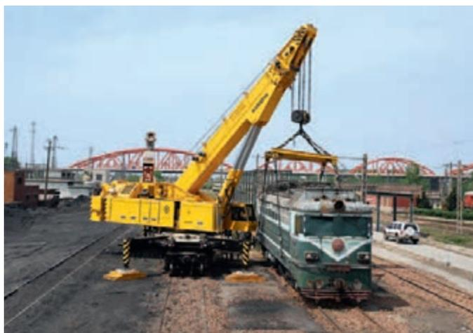
Рис. 3. Вращение противовеса вместе со стрелой при работе крана
