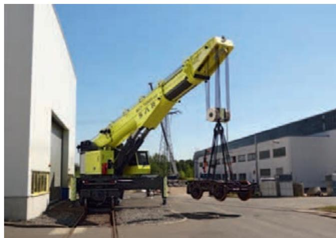
Рис. 4. Независимый поворот стрелы крана у стены
