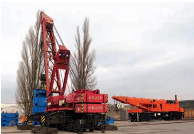
**Рис. 1.** Железнодорожный кран с жесткой решетчатой стрелой 1970-х годов и современный Multi Tasker KRC 1600 с телескопической стрелой
