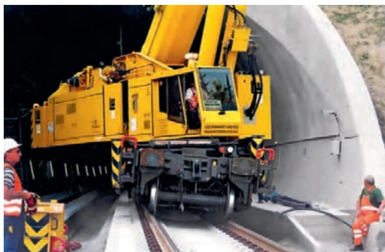
Рис. 8. Работа системы выравнивания (горизонтирования) верхней поворотной части крана Multi Tasker KRC
