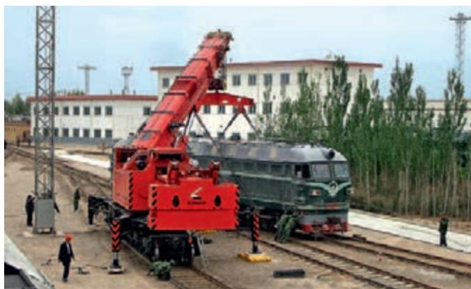
Рис. 6б. Независимый поворот стрелы крана KRC 1600
