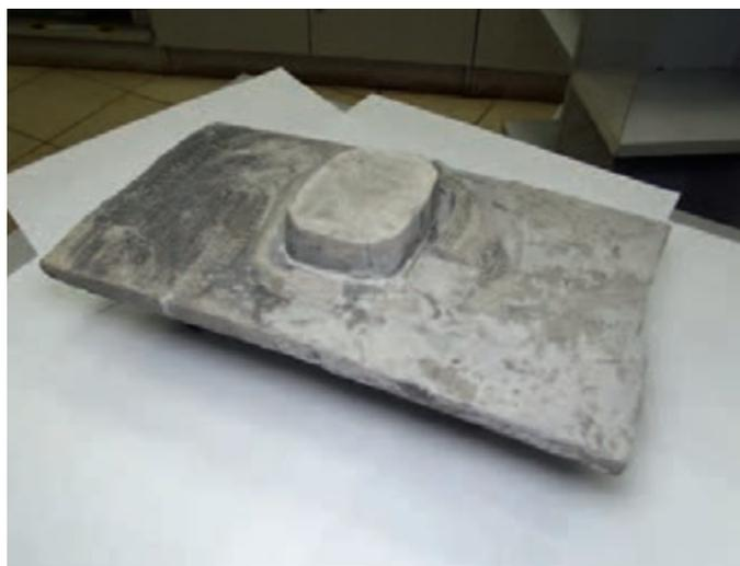
Рис. 3. Фрагмент старогодной шпалы. Сила сцепления выступа с подошвой  $P1_{сц} > 390 \text{ кгс}$
