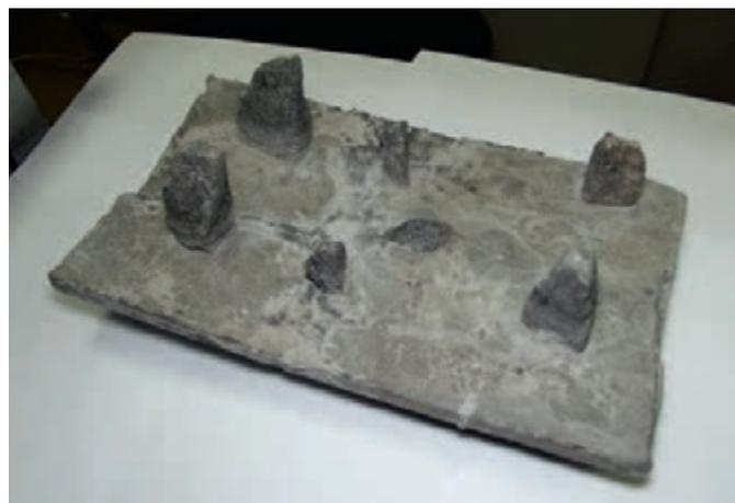
Рис. 2. Плита с вбетонированными щебенками после испытаний. Излом зуба при усилии излома  $P = 197 \text{ кгс}$
