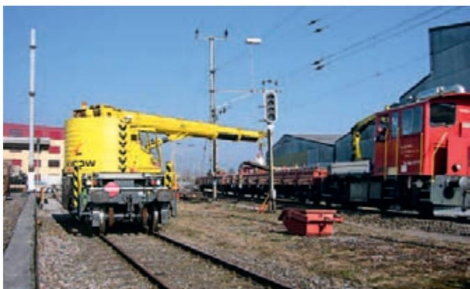
Рис. 5б. Работа крана KRC 100 с задним вылетом менее 2 м
