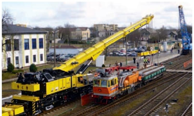
Рис. 2. Работа крана KRC 1600 LT с одним противовесом
