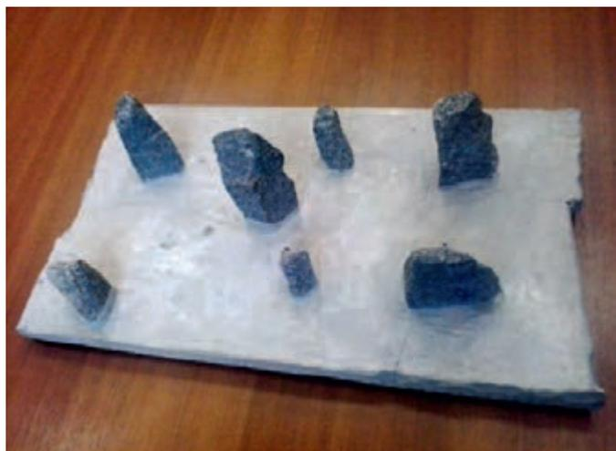
Рис. 1. Плита с вбетонированными щебенками до испытаний
