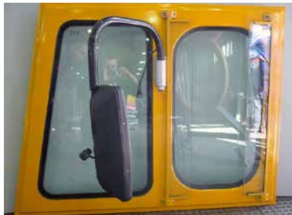
Рис. 5. Универсальный блок подвижного окна для путейских машин
