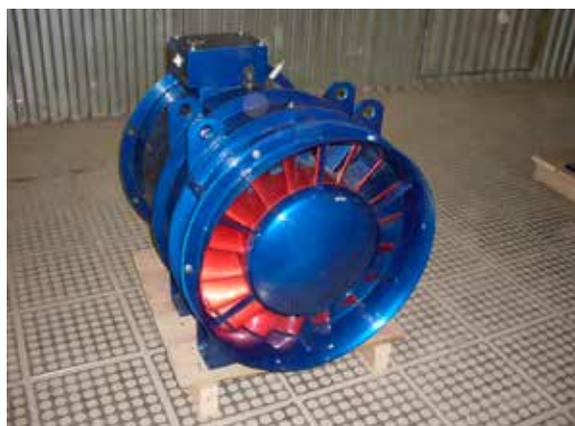
Рис. 2. Вентилятор охлаждения с комлевыми лопастями
