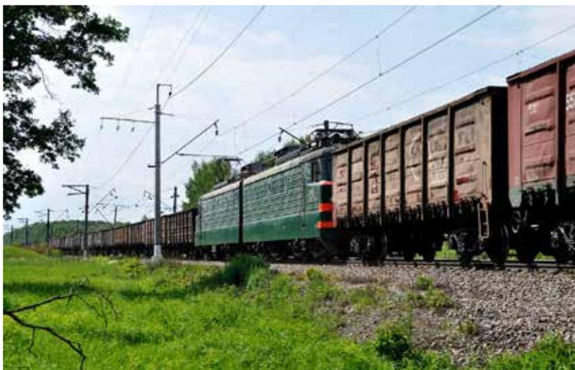
Рис. 5. Следование соединенного поезда в режиме автоведения с распределенными по составу локомотивами по системе ИСАВП-РТ
