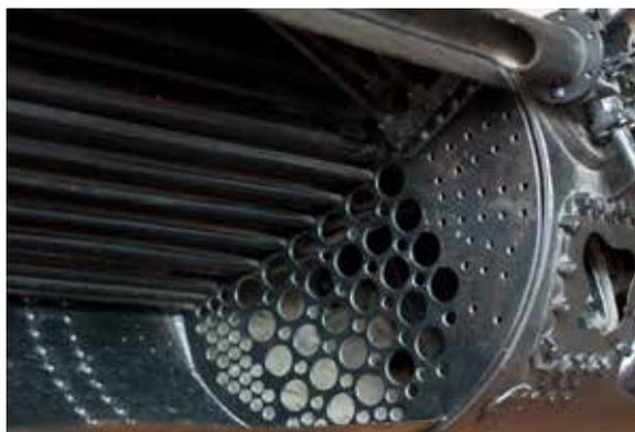
Разрез парового котла, дымогарные трубы паровоза середины XX века (такая же система использовалась и в первом паровозе Черепановых)
