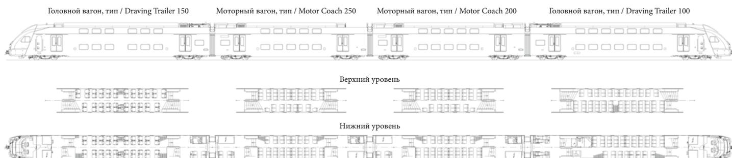
Рис. 1. ЭШ2 KISS RUS (АЭРО). Схема 4-вагонного поезда
