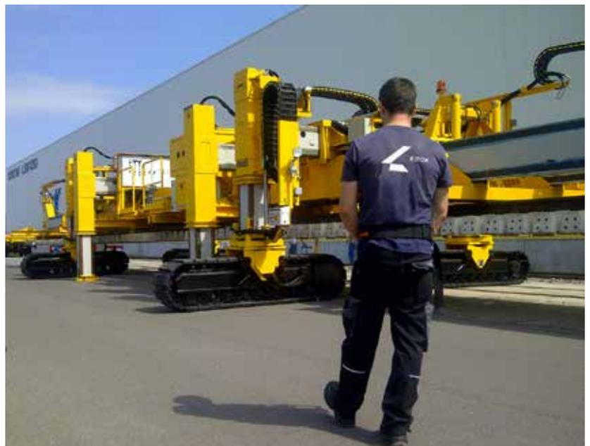
Рис. 4. Управление машины с помощью дистанционного пульта одним оператором
