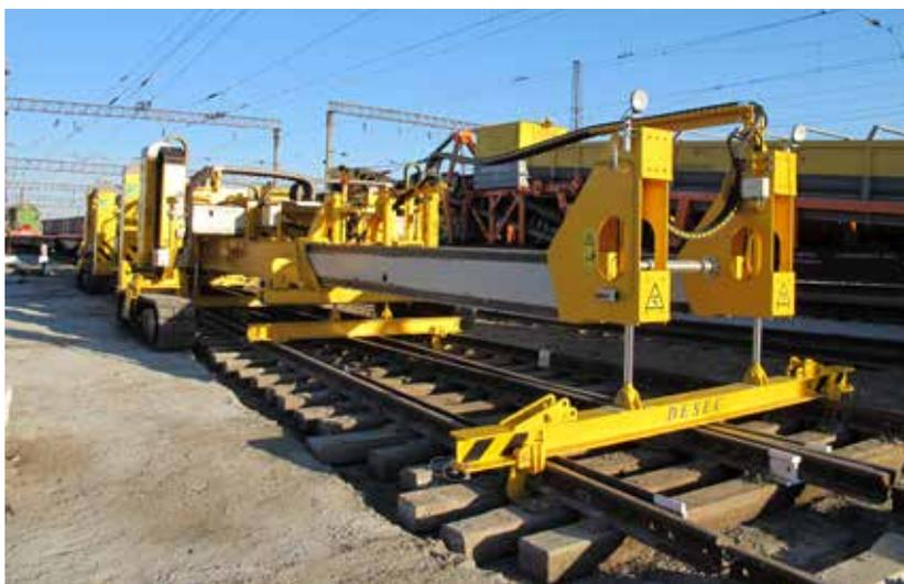
Рис. 1. Машина для замены стрелочных переводов DESEC Tracklayer
