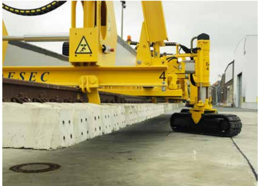
Рис. 3. Надежная фиксация стрелочного перевода под рамой машины DESEC Tracklayer при движении под углом  $45^\circ$
