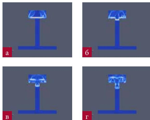
Рис. 18. Распространение упругих волн в рельсе с поперечной трещиной в головке
