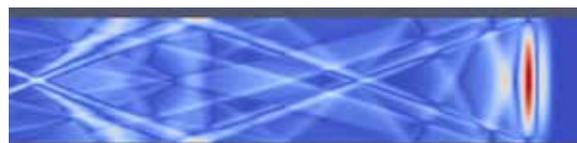
Рис. 3. Распространение упругих волн в рельсе. Характерная волновая картина
