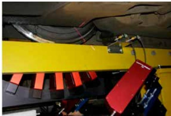
Рис. 2. Элементы напольного оборудования системы LASCA
