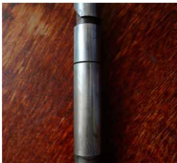
**Рис. 6.** Неисправная плунжерная пара (износ) ТНВД дизеля тепловоза ТЭМ-2 № 6124
