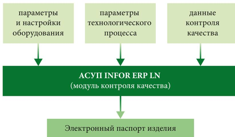
Рис. 1. Система сбора параметров оборудования, технического процесса и продукции и интеграция их в электронный паспорт изделия
