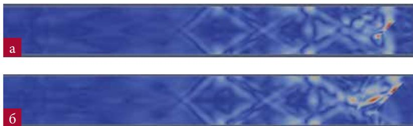
Рис. 21. Формирование отклика от трещины в шейке рельса
