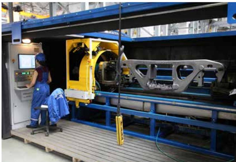
Рис. 4. Контроль отливок после термообработки в установке магнито-поршневого контроля железнодорожного литья (УМК ЖЛ)
