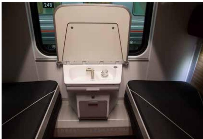
Рис. 2. Умывальник, находящийся под столиком
