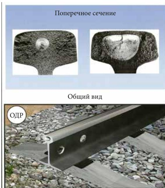
Рис. 15а. Поперечная трещина в головке. Код дефекта 20 1-2
