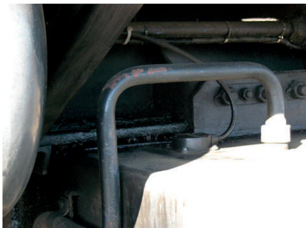
Рис. 3. Датчик LLS в топливном баке тепловоза
