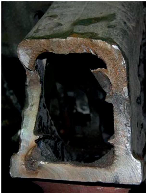
Рис. 3. Поверхность излома отливки «Рама боковая»
