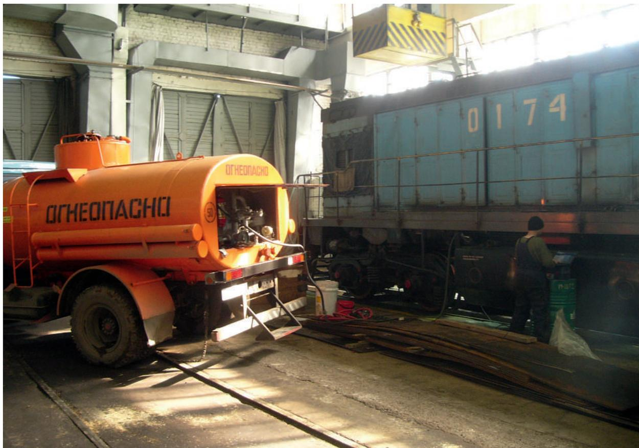
Рис. 5. Процесс тарировки топливного бака тепловоза
