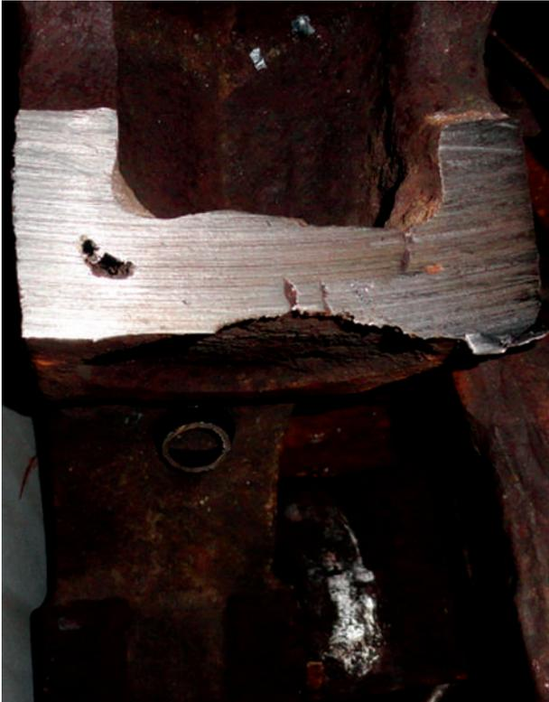
Рис. 2. Поверхность реза отливки «Рама боковая» с усадочной и свищевидными газовыми раковинами
