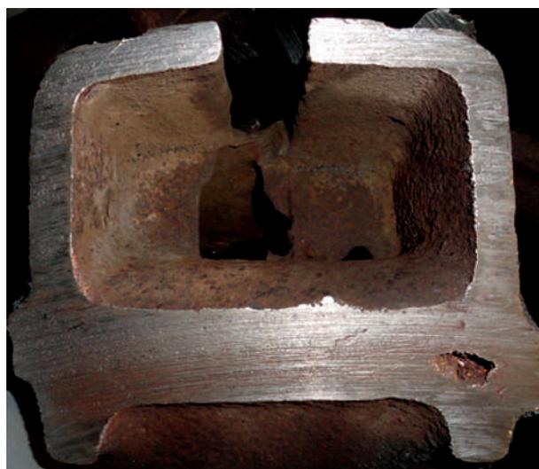
Рис. 1. Поверхность реза отливки «Рама боковая» с усадочной раковиной в правой ее части
