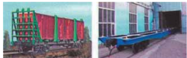
Рис. 10. Фитинговая платформа модели 1397-44
