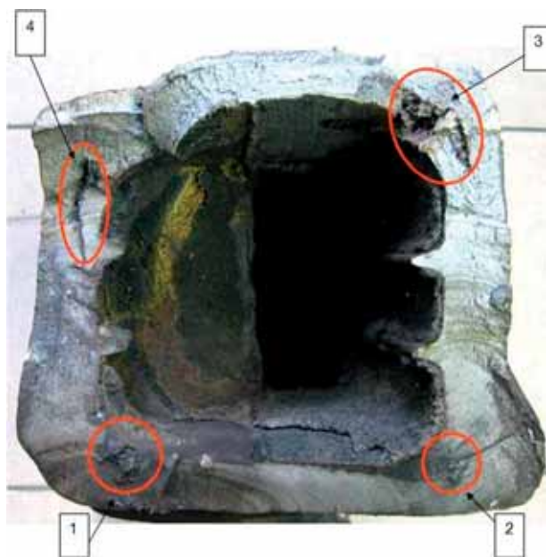
Рис.8. Фрагмент отливки «Рама боковая» с усадочными дефектами
