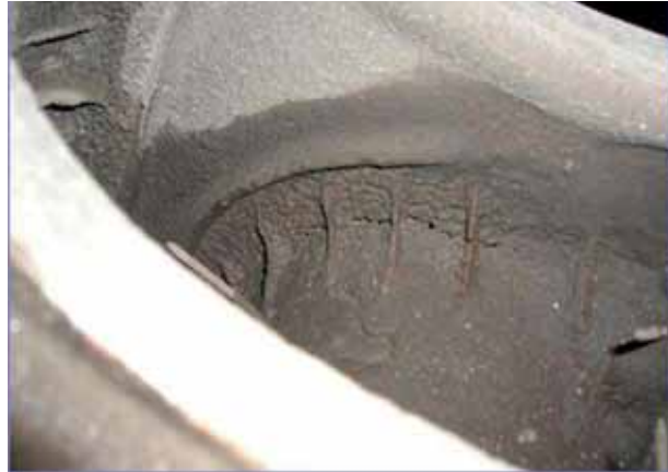
Рис.6. Фрагмент отливки «Рама боковая» с упрочняющими ребрами и горячей трещиной в термическом узле
