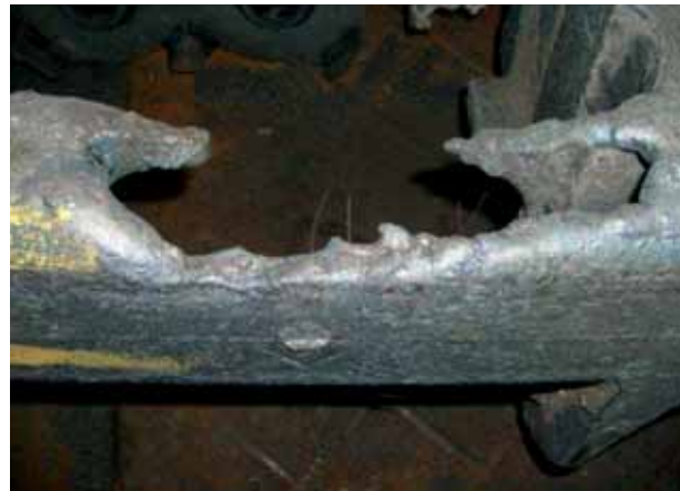
Рис. 1. Фрагмент отливки «Рама боковая» с недоливом металла
