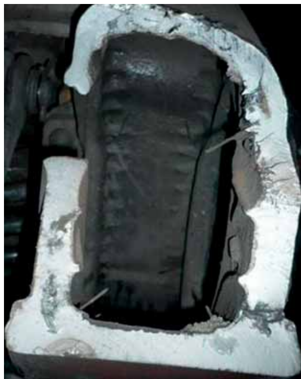
Рис.9. Фрагмент отливки «Рама боковая» с газовыми раковинами на поверхности излома
