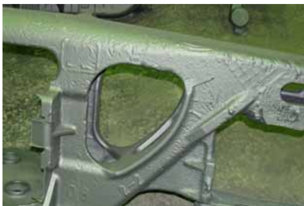
Рис. 3. Фрагмент отливки «Рама боковая», поверхность которой покрыта окисными пленами
