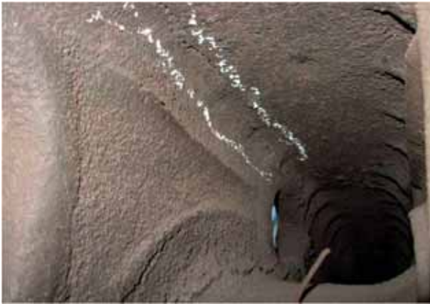
Рис. 5. Фрагмент отливки «Рама боковая» с упрочняющими ребрами и горячей трещиной
