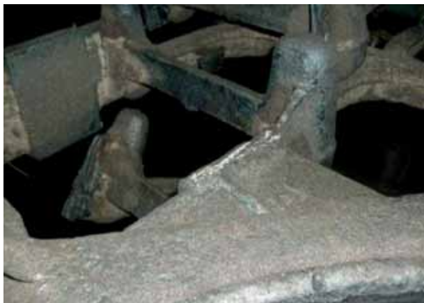
Рис. 2. Фрагмент отливки «Рама боковая» с недоливом ребра, помеченного мелом
