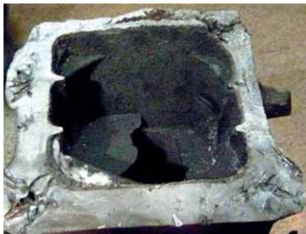
Рис. 7. Фрагмент отливки «Рама боковая» с усадочными дефектами
