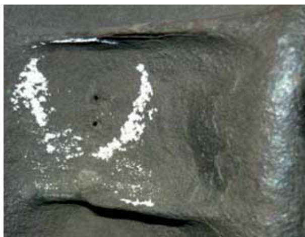
Рис.10. Фрагмент отливки «Рама боковая» с газовыми раковинами на внутренней поверхности
