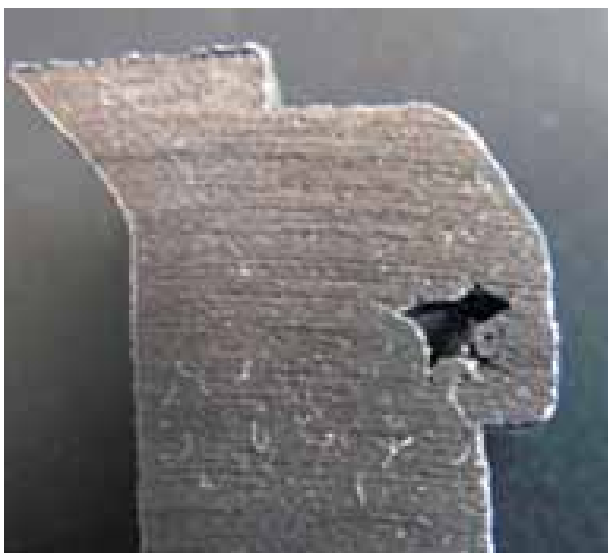
Рис. 2.в. Фрагмент отливки «Крышка» с дефектом (увеличено)
