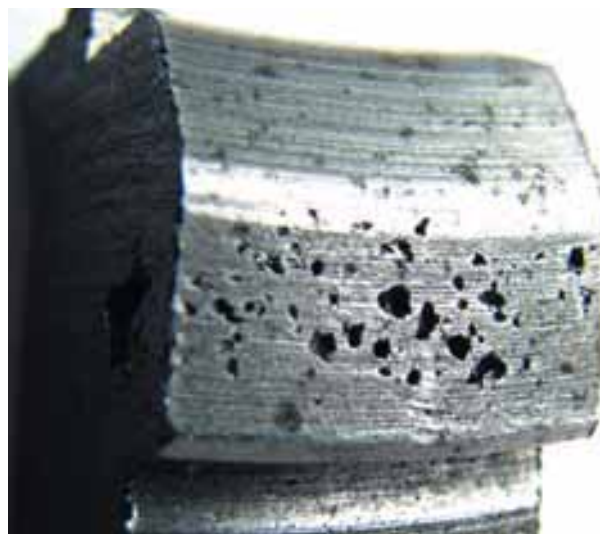
Рис. 2.б. Фрагмент отливки «Крышка» с газовыми раковинами
