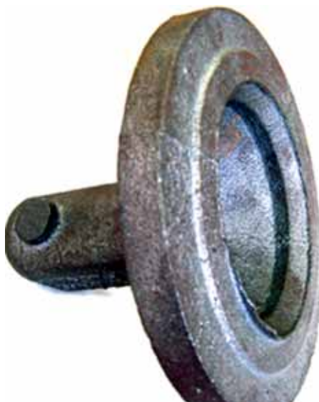
Рис. 2.а. Отливка «Крышка» с невидимыми дефектами
