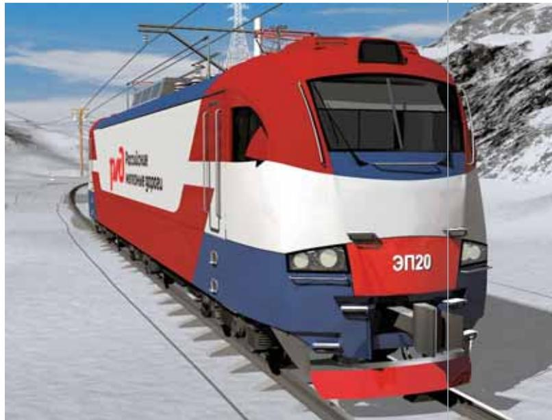
приступил в 2008 году к проектированию пассажирского односекционного двухсистемного электровоза ЭП20 с асинхронными тяговыми двигателями. Работа ведется в тесной кооперации с ведущими производителями оборудования для железнодорожного машиностроения.
