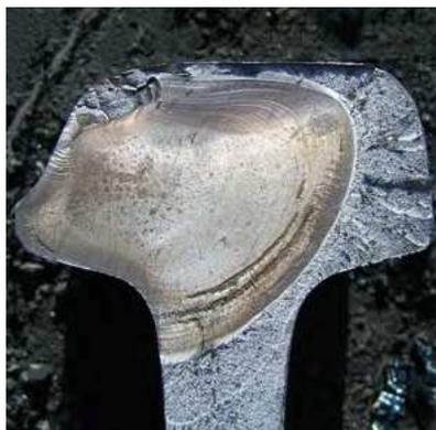
**Рис. 2а.** Интенсивность бокового износа меньше оптимального значения, предотвращающего развитие дефектов контактной усталости
