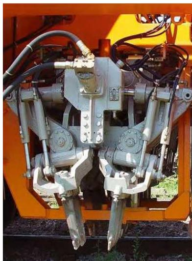
**Рис. 5.** Каретка с подбивочным блоком: 1 – вертикальные направляющие; 2 – привод перемещения подбивочного блока; 3 – подбивочный блок; 4 – подбойки; 5 – привод подбоек; 6 – распределительная, регулирующая и приемо-передающая аппаратура; 7 – тяговый орган; 8 – дополнительный привод каретки
