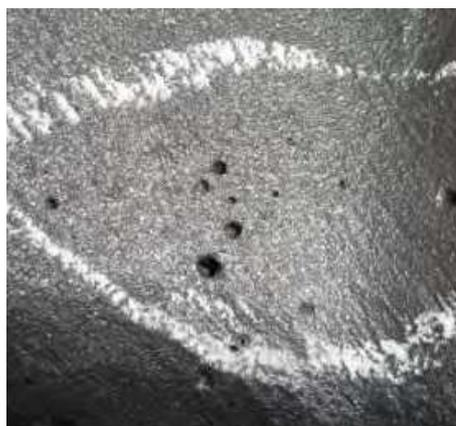
Рис. 1. Газовые окисленные раковины со стороны формы
