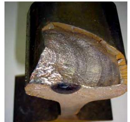
Рис. 1. Развитие продольных (с переходом в поперечные) трещин от поверхности головки рельсов
