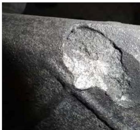
Рис. 4. Земляная раковина на поверхности отливки
