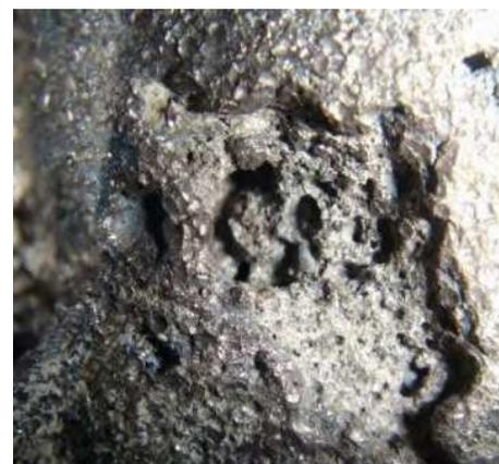
Рис. 3. Шлаковая раковина на поверхности отливки
