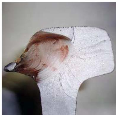
**Рис. 2б.** При значительном боковом износе зона контакта и место образования контактно-усталостных трещин может смещаться в нижнюю часть головки рельса
