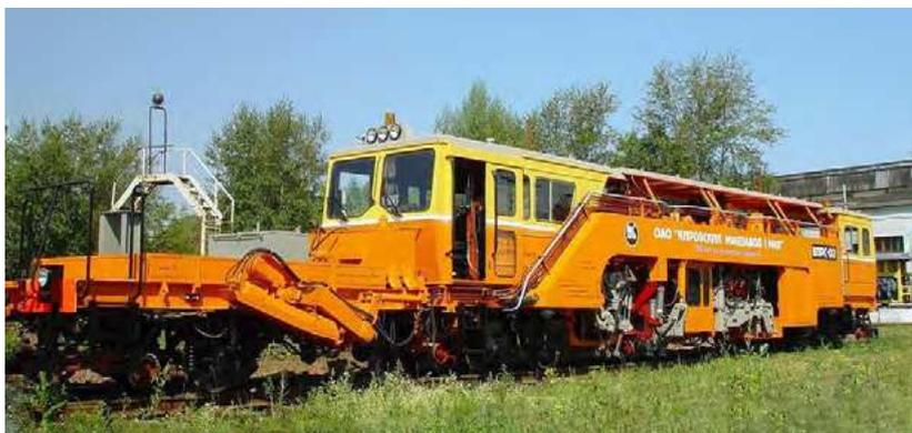
**Рис. 1.** Машина для осуществления способа непрерывной подбивки шпал железнодорожного пути
