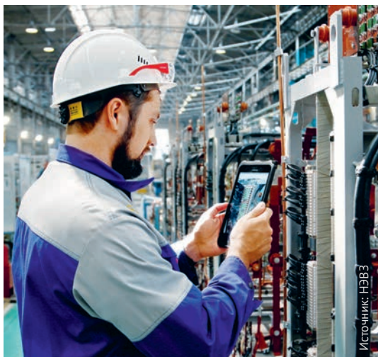
Применение технологии компьютерного зрения при эталонной проверке качества собранного узла на НЭВЗ
