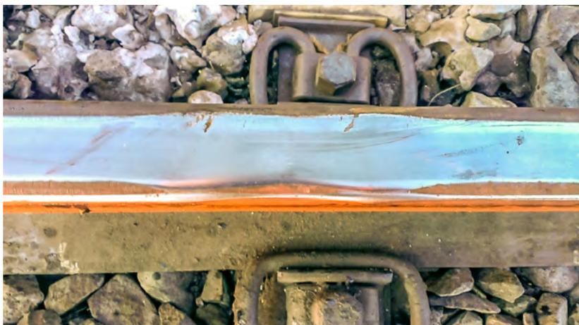
Рис. 3. Внешний вид седловин и выкрашиваний металла в зоне термического влияния при термообработке сварного шва по серийной технологии
