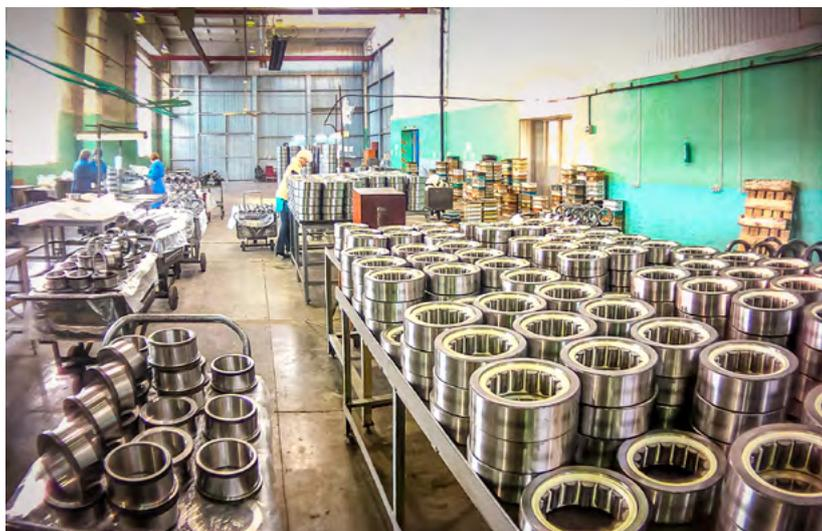
Рис. 1. Партия цилиндрических буксовых вагонных подшипников перед проведением инспекционно-приемочного контроля специалистами ЦТА ОАО «РЖД» на ОАО «ЕПК Саратов»
