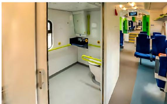
Рис. 3. Многофункциональный туалетный комплекс вакуумного типа
