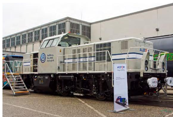
Гибридный маневровый тепловоз H3 (производитель: Alstom)
