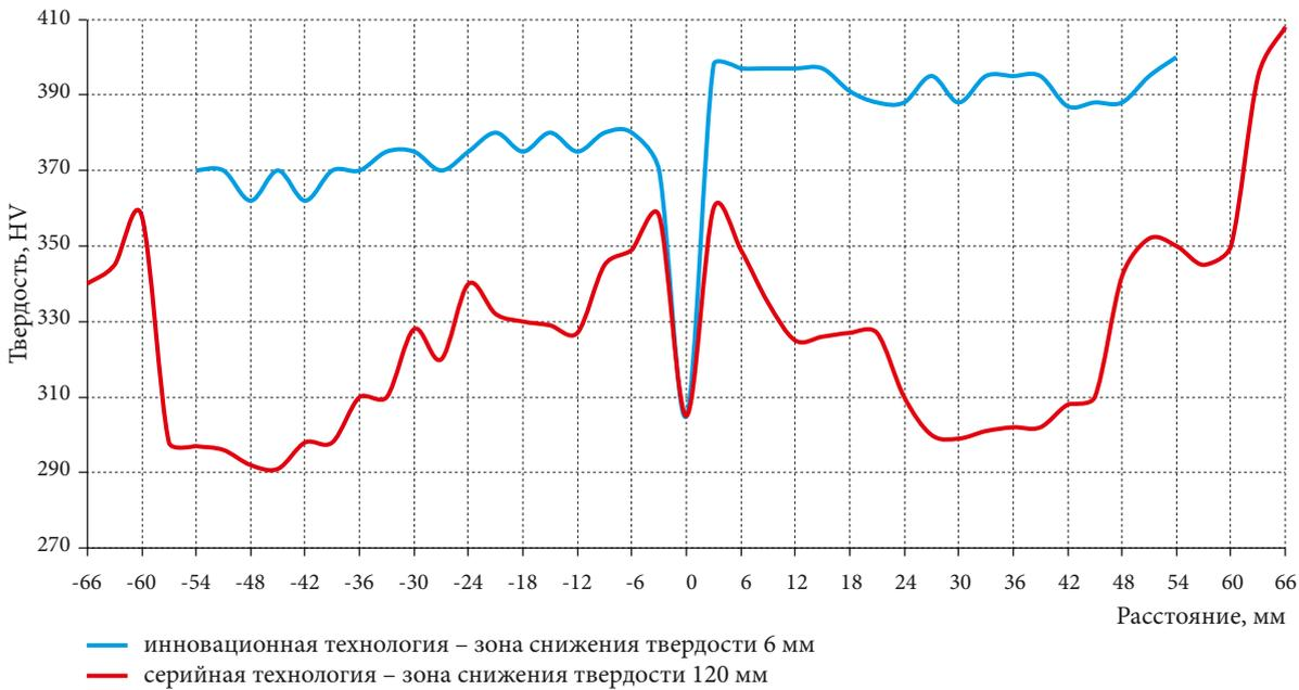
Рис. 4. Распределение твердости в зонах сварного шва и термического влияния на продольных темплатах
