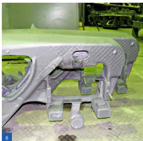
Рис. 2а) БР с двутавровым сечением; 2б) БР с коробчатым сечением
