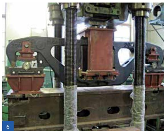
Рис. 4а) Ходовые прочностные испытания тележки Barber S-2-R; 4б) Стендовые прочностные испытания тележки Barber S-2-R
