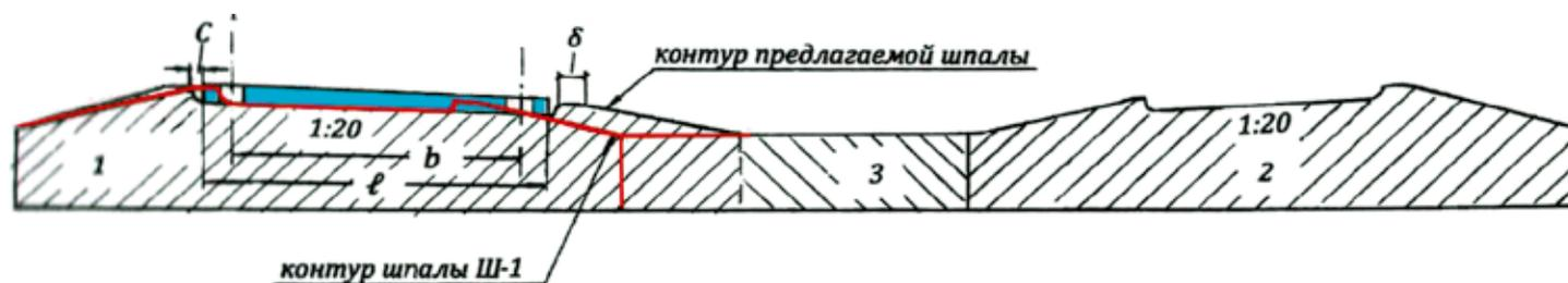
**Рис. 1.** Предлагаемая конструкция железобетонной шпалы:
