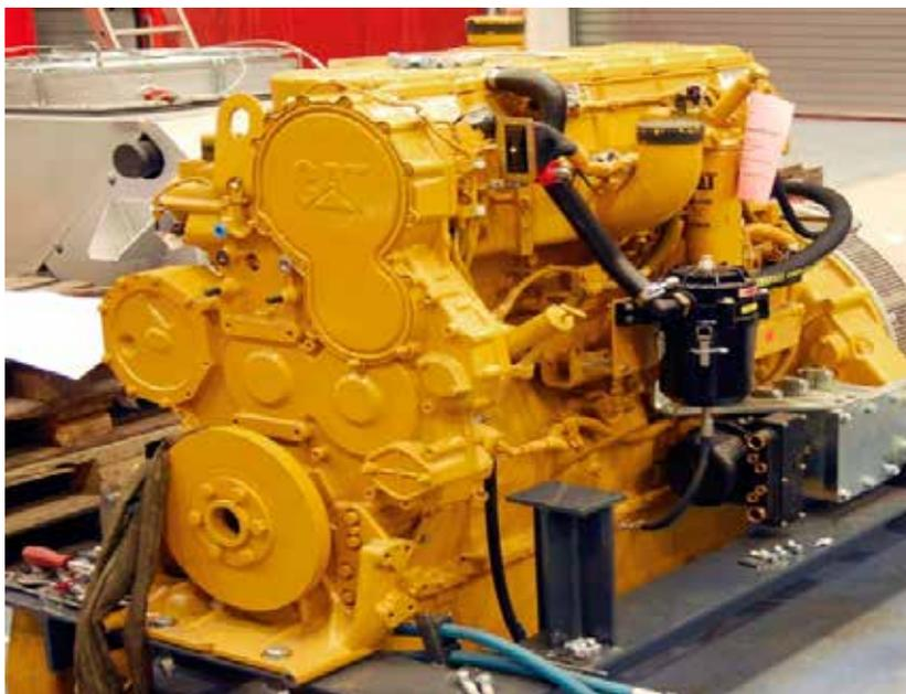
Рис. 2. Дизель-генератор типа Caterpillar C15
