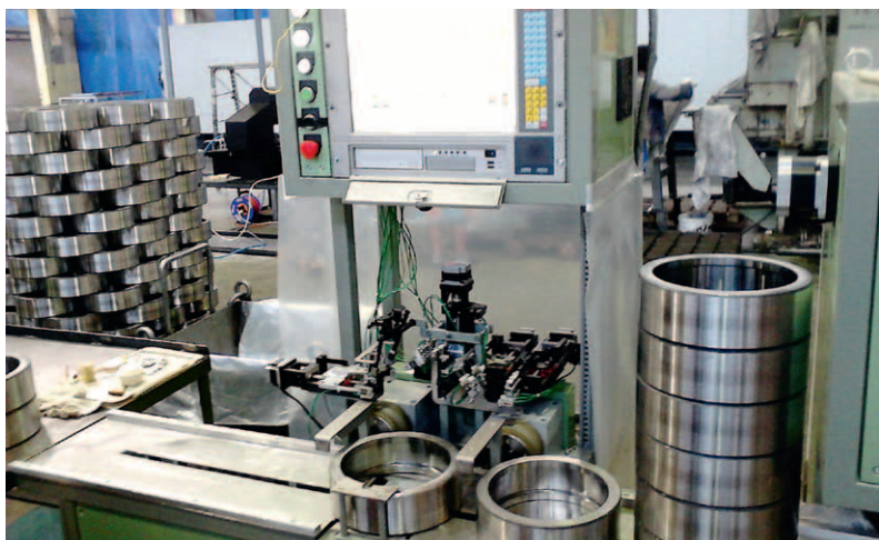
Рис. 3. Участок вихретоковой дефектоскопии наружных колец буксовых вагонных подшипников
