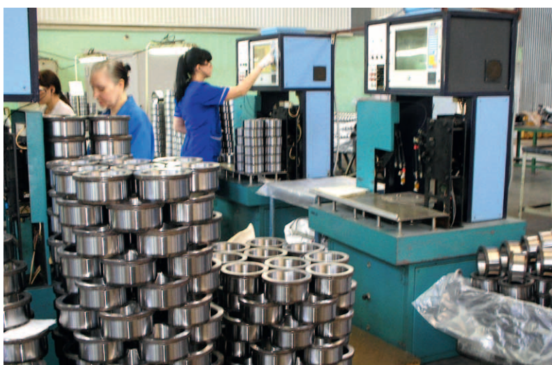
Рис. 4. Участок вихретоковой дефектоскопии внутренних колец буксовых вагонных подшипников 42726
