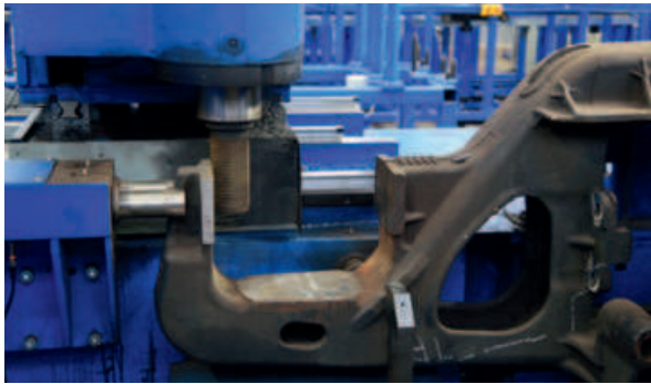
Рис. 3. Фрезерная обработка наплавленной поверхности детали «Рама боковая»
