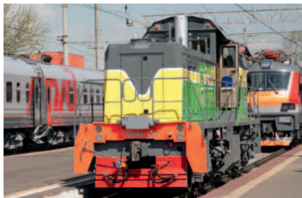
Рис. 2. Тепловоз с гибридным приводом SinaraHybrid
