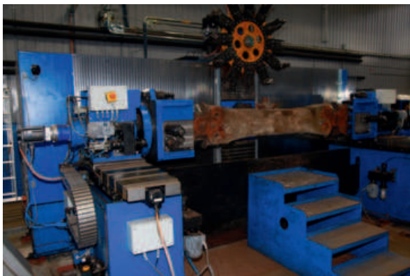
Рис. 4. Станок специальный для обработки детали «Балка наддрессорная»
