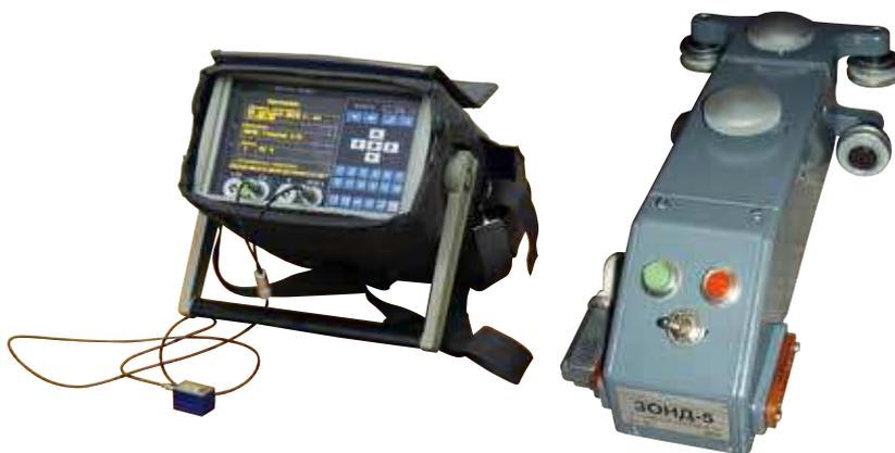
Рис. 2. Дефектоскоп УДС2-52 (слева) и сканирующее устройство (справа)
