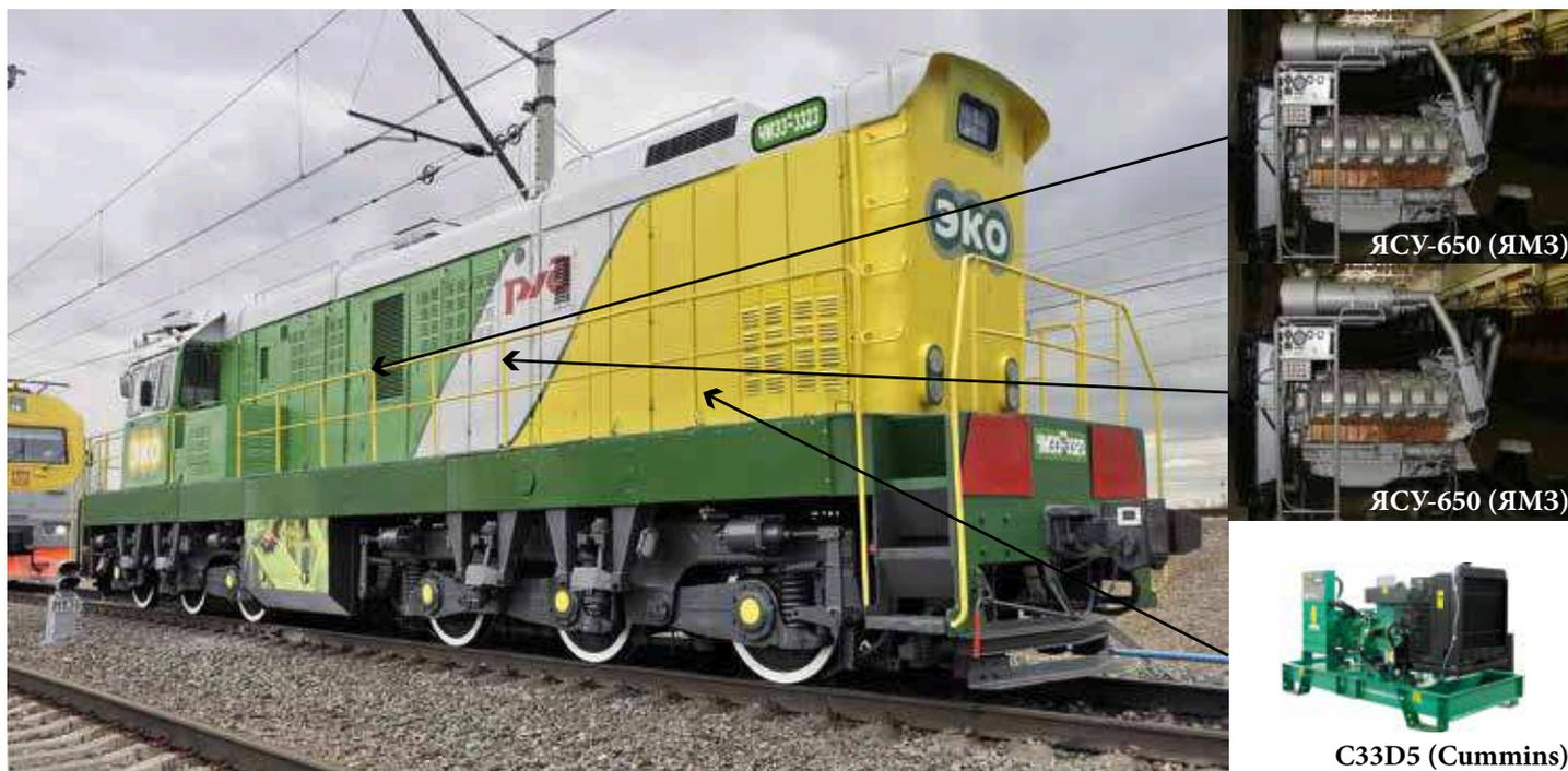
Рис. 7. Модернизированный маневровый тепловоз ЧМЭЗ с трехдизельной силовой установкой мощностью по дизелям 2×478 кВт + 1×75 кВт, производство ОАО «Ярославский моторный завод» (ЯМЗ)
