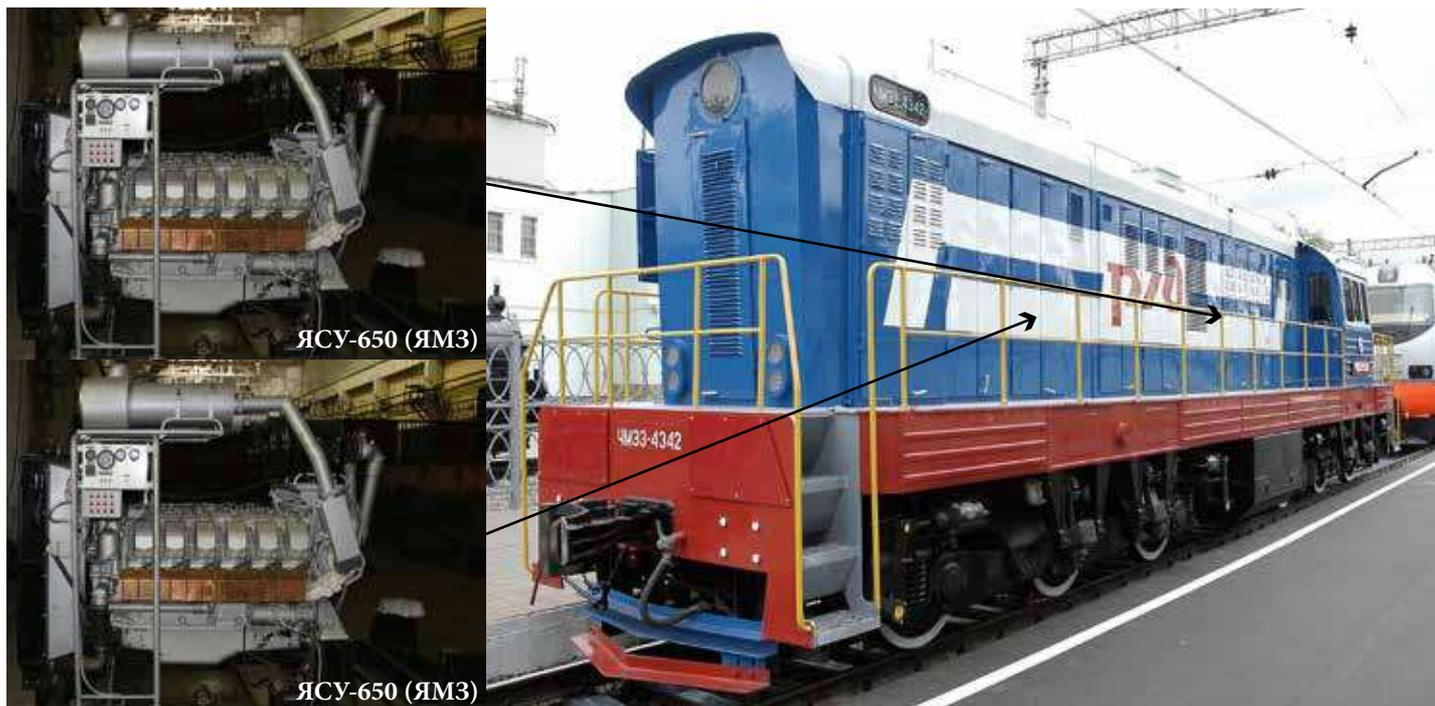
Рис. 6. Модернизированный маневровый тепловоз ЧМЭЗ с двухдизельной силовой установкой мощностью по дизелям 2×478 кВт, производство ОАО «Ярославский моторный завод» (ЯМЗ)
