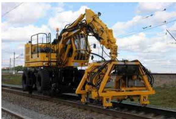
Погрузчик-экскаватор на комбинированном ходу марки KGT-4RS
