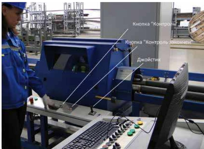
Рис. 1. Рабочее место оператора на установке УМК-ТТ.1
