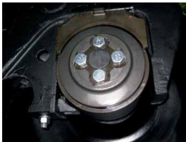
Рис. 4. Конструкция буксового проема с адаптером и блокиратором
