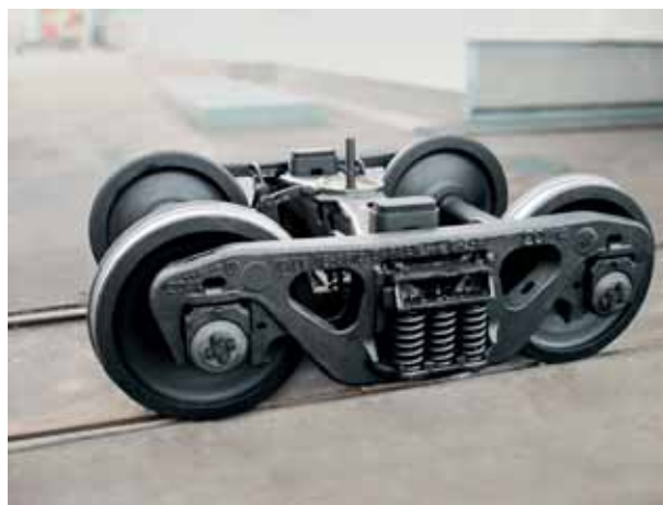
Рис. 1. Тележка модели 18-9810 типа Barber S-2-R с осевой нагрузкой 23,5 тс
