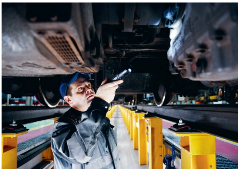
Осмотр вагона метро в ООО «Метровагонмаш-Сервис» со специальным бесконтактным устройством, разработанным «Триалинк» совместно с 2050.digital (входит в ГК Ctrl2GO)
